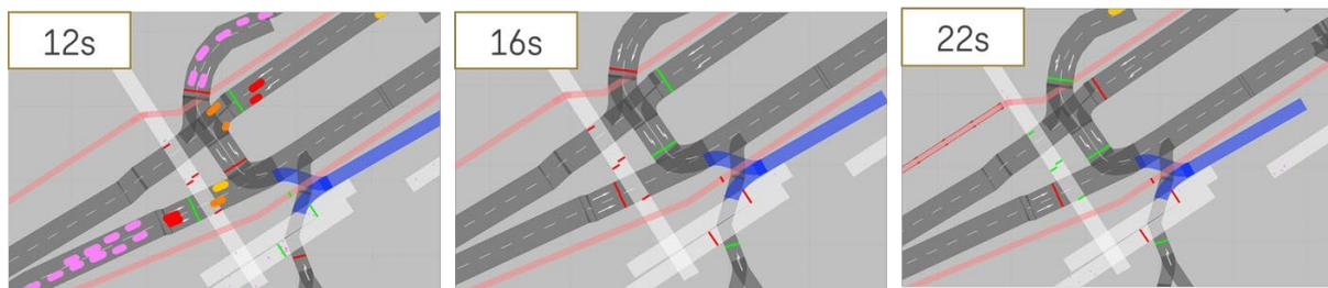
Figure 95 : Détail de la régulation par feux du carrefour Cliquet dans le scénario D (SWECO, 2019).
