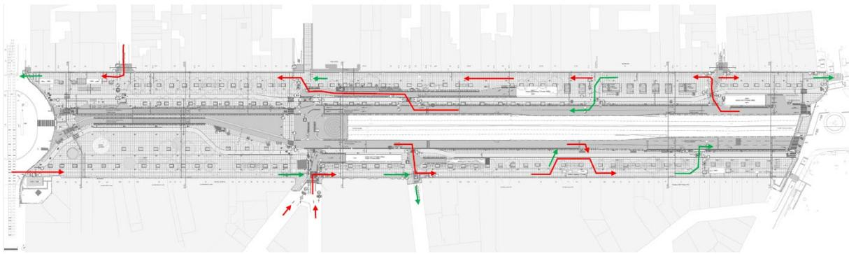
Figure 103 : Accès pour les véhicules utilitaires, de secours et les livraisons
