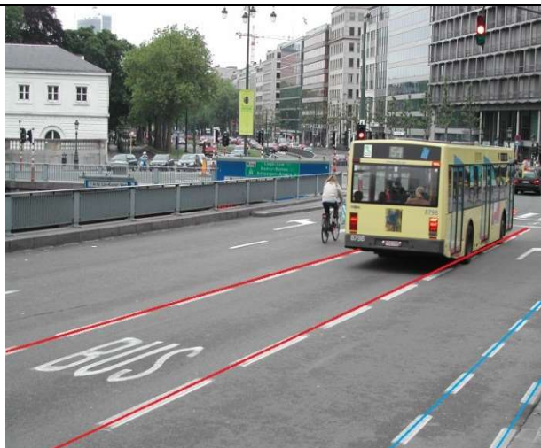
De onderbroken witte strepen (vrije busbaan) worden voorgesteld in de laag « 126_ligne_discontinue » (rode lijnen). De onderbroken witte strepen voor fietspaden worden voorgesteld in de laag « 124_Piste_cyclable » (blauwe lijnen).
