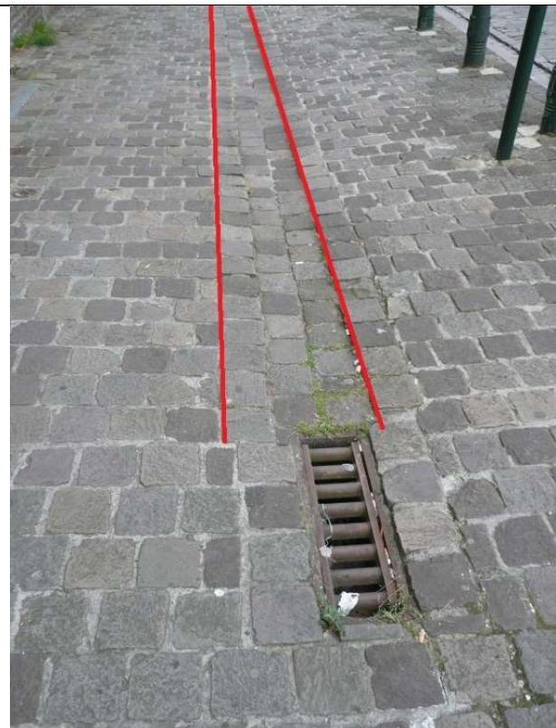
De twee randen van de watergreppels (afvoergeulen) worden opgenomen en voorgesteld in de laag « 381_Filet_eau ».
