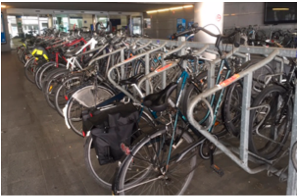
13 - Râteliers en surélévation alternée – Gare du Nord
