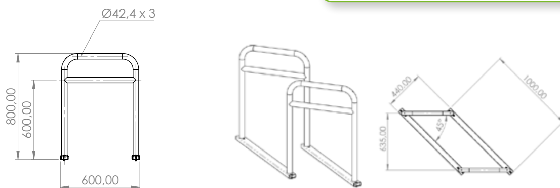
11 - Dimensions des arceaux en U renversé à barre transversale fournis par Bruxelles Mobilité (2021)
