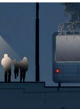
Eclairage de la plateforme Piétonnier, optique asymétrique > Fonctionnel piéton
