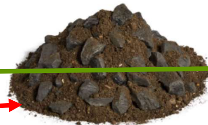
Mélange Terre-pierre | Bomengranulaat 60 % de pierres, steen, 20 mm - 40 mm 40 % de terre végétale, bovengrond
