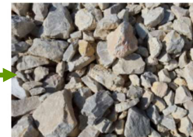
Empiècement massif drainant | Steenslag grindkoffer Taille des grave comprise entre 20mm et 60mm Steengrootte tussen 20 mm en 60 mm
