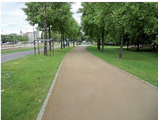
Figuur 37 – Tervurenlaan, Sint-Pieters-Woluwe, dubbelrichtingsfiets- en wandelpad – Een weg voorbehouden voor fietsers en voetgangers (aangeduid door verkeersbord F99a) kan in bepaalde situaties (vb. in groene omgeving) ook in okerkleur worden aangelegd.
