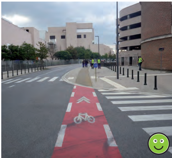
Figuur 72 – Fietspad loopt rechtdoor over het kruispunt.
