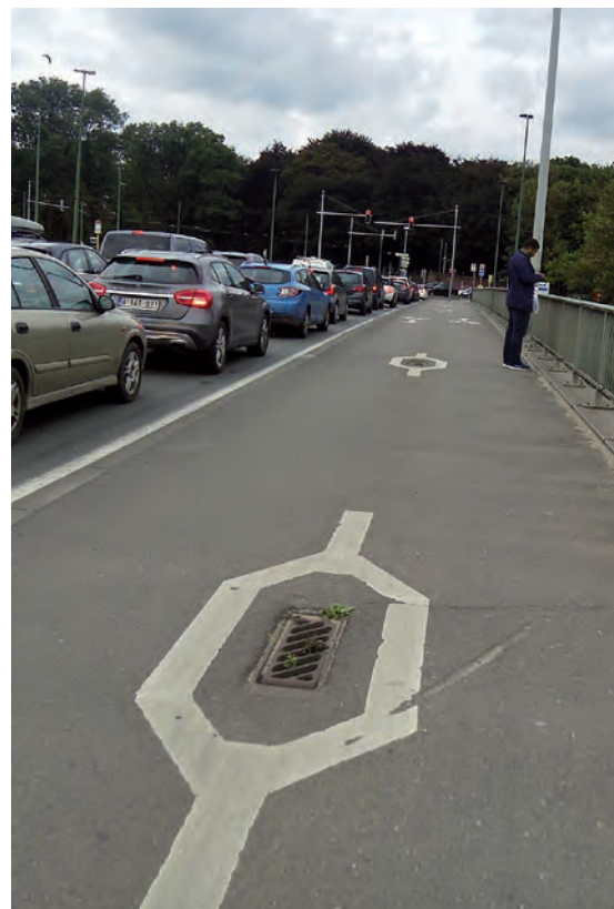
Figuur 67 – Van Praetbrug – De waterkolken worden (net zoals bij paaltjes) met ribbelmarkering aangegeven.
