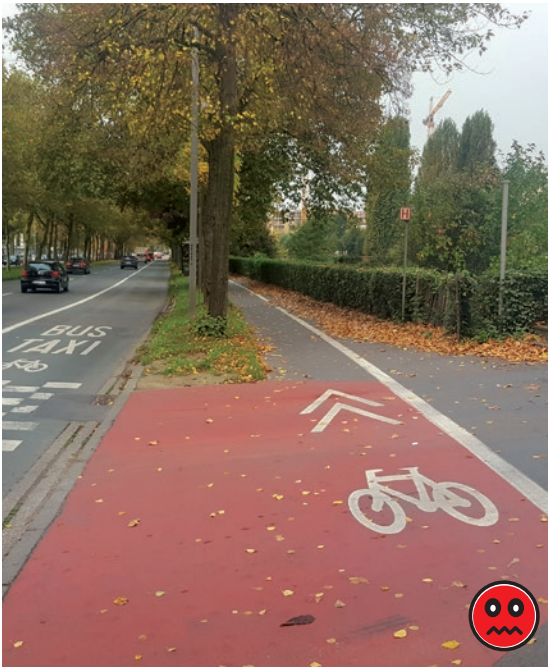
Figuur 43 – Rodekaai – Rodekaai – In dit voorbeeld laat de bestaande bomenrij te weinig ruimte over voor een voldoende breed fietspad. Door hiervan een F99a inrichting te maken en (snelle) fietsers op de busbaan toe te laten, zou dit het aantal conflicten tussen voetgangers en fietsers moeten verminderen.
