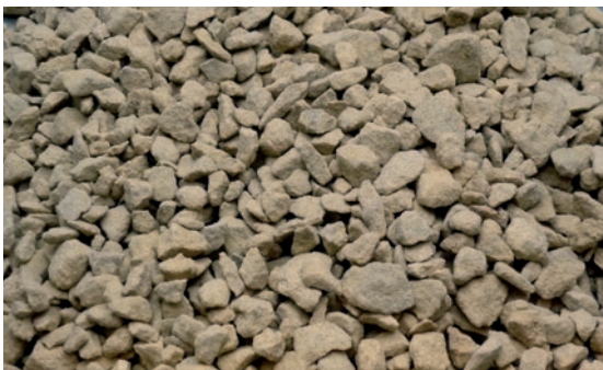
Gele zandsteenaggregaten voor de bereiding van gekleurde asfalmengsels.
