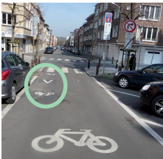
Fietsstraat met BEV in Jette, met kleine symbolen voor fietsers die de straat in de tegengestelde richting nemen.
