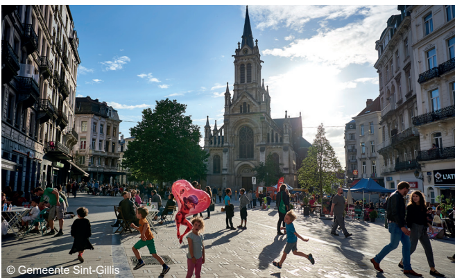
Sint-Gillisvoorplein (St-Gillis): voetgangersverhardingen van graniet met een gevlamde afwerking (grotendeels) afgewisseld met gezoete blauwe steen, met een goede gebruikskwaliteit voor de voetgangers
