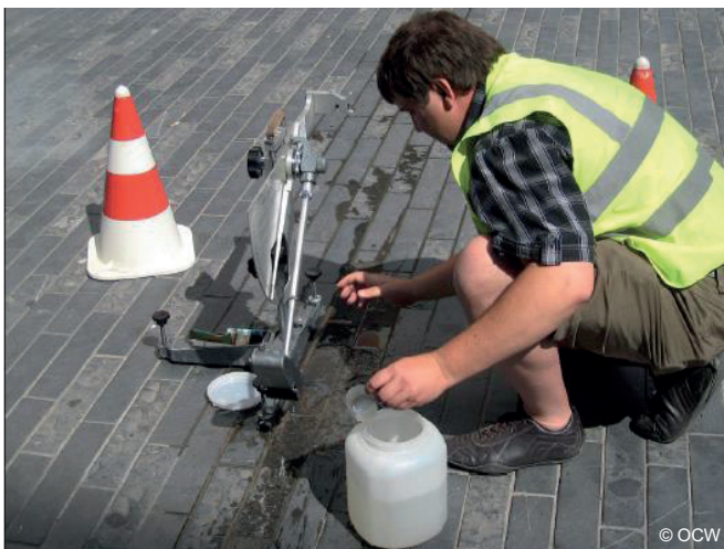
Meting van de stroefheid van een voetgangeroppervlak met behulp van de SRT-slinger
