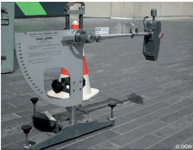
Meting van de stroefheid van een voetgangeroppervlak met behulp van de SRT-slinger
