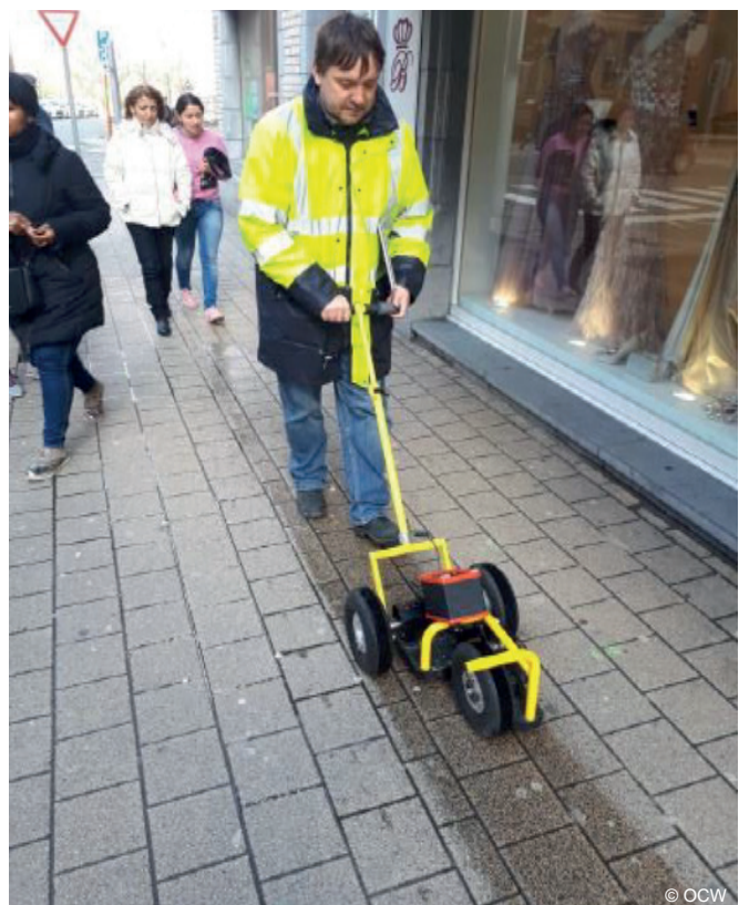
Continue stroefheidsmeting met PFT-toestel
