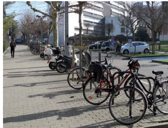
Fietsbogen in omgekeerde U-vorm op het trottoir maar aan de overzijde van de natuurlijke gidslijn, waardoor een meer dan 2 m brede doorgang vrij blijft.
