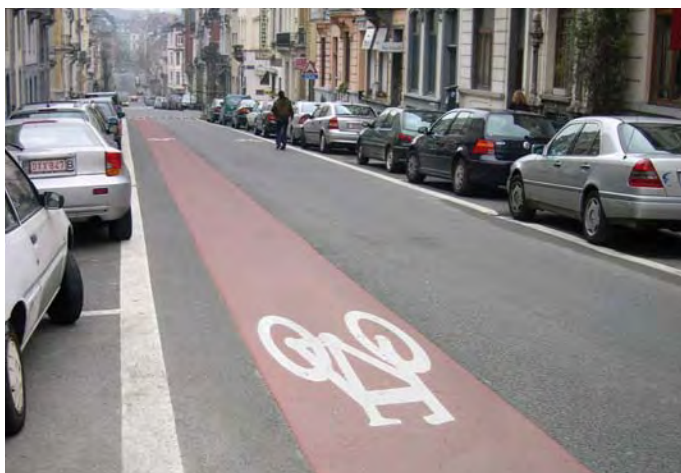
Figuur 8.12. – FSS in tegenrichting voorzien van logo's en vergezeld van de logo's "in de richting" aan de andere kant van de weg.
