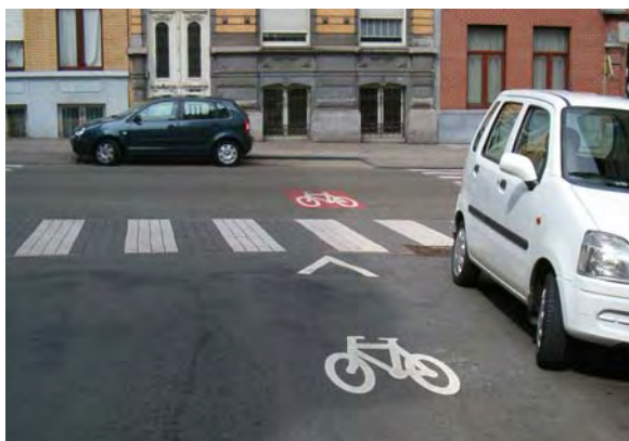
Figuur 3.1. – Fietslogo op rode ondergrond om de aanwezigheid aan te geven van fietsers die voorrang hebben.
