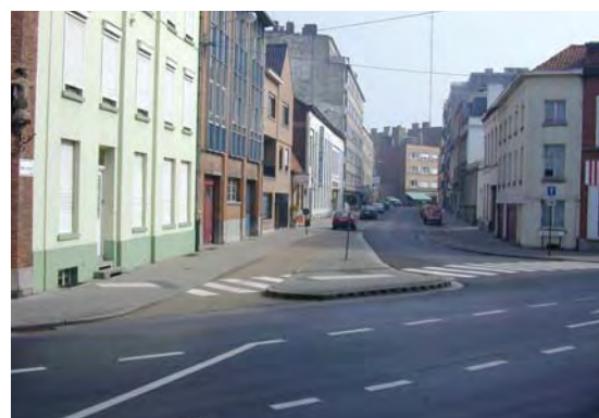
Figuur 9.2. – Verkeersheuvel aan het eindstuk van een voor fietsers toegelaten tegenrichting.
