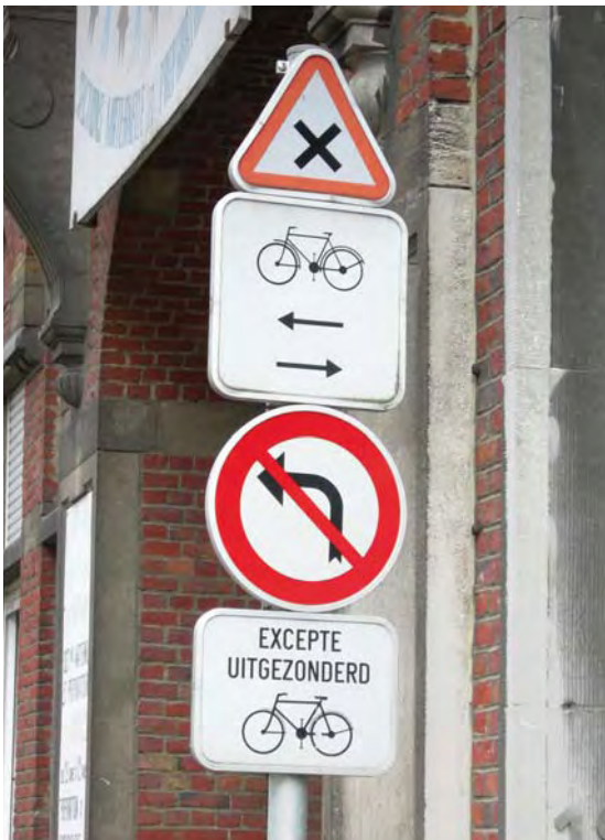
Figuur 10.6. – De verkeersborden C31 en M2 worden geplaatst als de zichtbaarheid van het verkeersbord C1 op de dwarsweg niet voldoende zichtbaar is.
