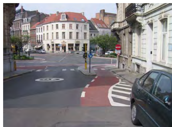
Figuur 9.3. – op dit kruispunt, is het verboden voor fietsers om aan het einde van de tegenrichting rechtdoor te rijden of links af te slaan. Daarom werd er een verkeerseiland aangebracht dat hen naar rechts leidt.
