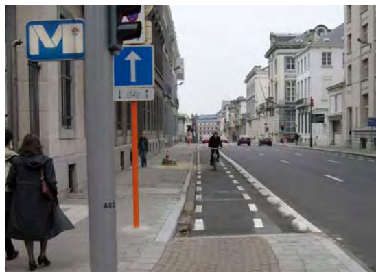
Figuren 8.7. en 8.8. – Voorbeelden van een fysieke scheiding van een voor fietsers toegelaten tegenrichting.
