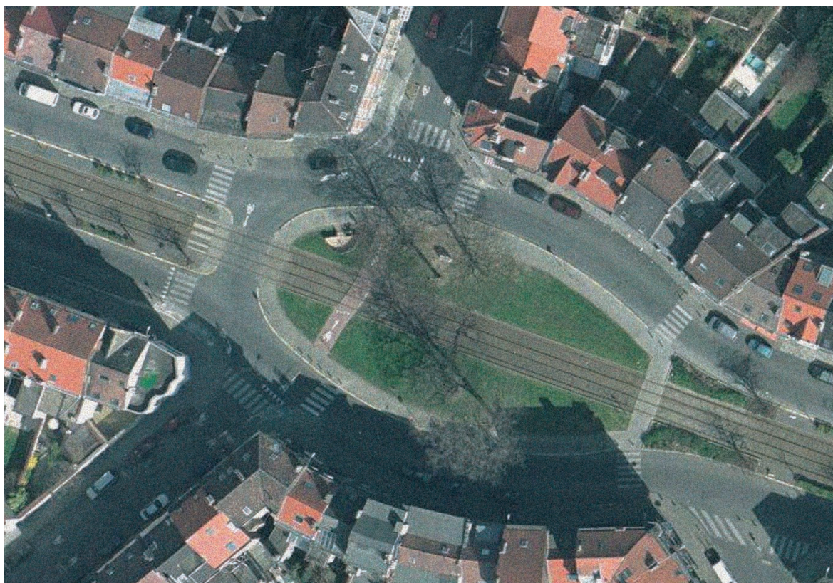
Figuur 4.33 – Bij deze inrichting die men als semi-rotonde of ovonde zou kunnen kwalificeren, kunnen de fietsers het middeneiland oversteken zonder een omweg te moeten maken.
