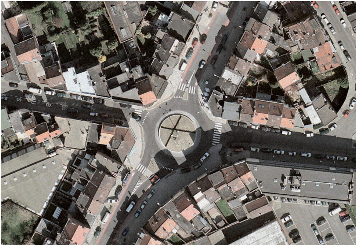
Figuur 4.1 – Voorbeeld van een compacte rotonde met één rijstrook waarvoor geen bijzondere fietsinrichting nodig is
