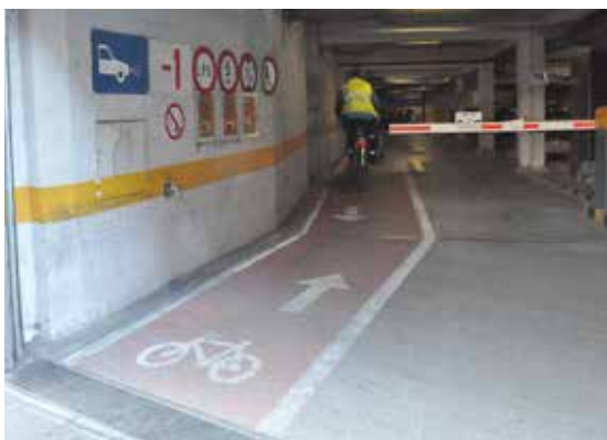
Zorg voor belijning bij een gemengde parking voor auto's en fietsen.
