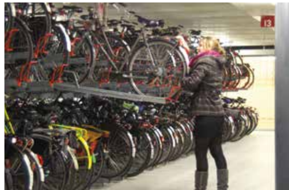
Door het gebruik van gasveren vormt het tilgewicht bij etagerekken geen obstakel meer.
