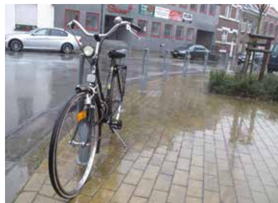
Een fraaie antiparkeervoorziening in Woluwe die tegelijkertijd een aanbindmogelijkheid voor fietsen biedt. Helaas kan dit systeem niet worden aanbevolen. De fiets wordt slechts op één punt ondersteund waardoor die zonder standaard snel kan vallen. Zo dicht bij de weg is dat helemaal niet ideaal.
