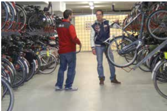
Door het gebruik van gasveren vormt het tilgewicht bij etagerekken geen obstakel meer.
