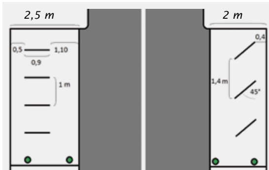
Links: een breed parkeervlak waarbij de beugels haaks op de weg kunnen worden geplaatst. Rechts: een smal parkeervak van twee meter waarbij de beugels onder een hoek van 45° worden geplaatst.
