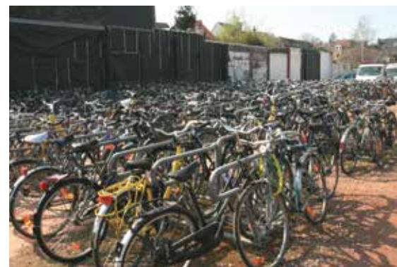
Boven is er duidelijk moeite genomen om de beugels op een goede ondergrond te plaatsen. Onder: gravel is geen goede ondergrond omdat het regenwater niet goed weg kan.
